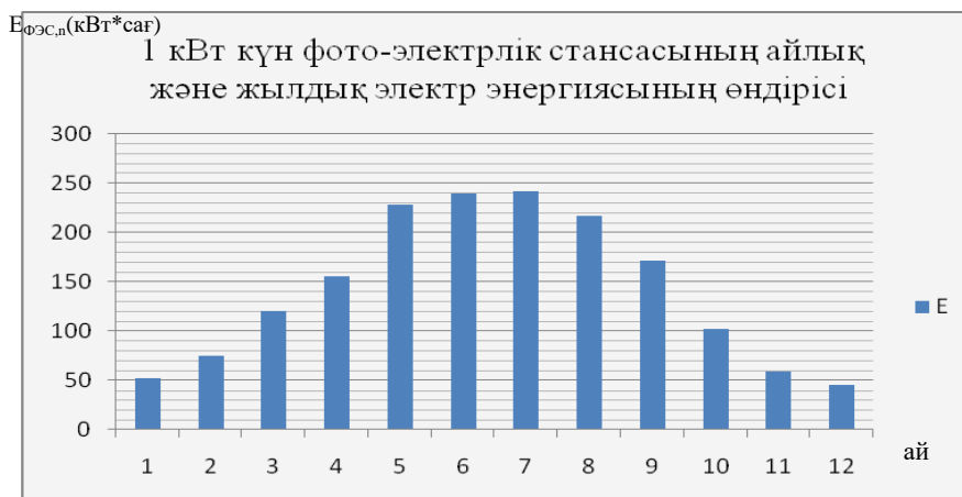
Сурет 4. 1кВт күн фотоэлектрлік стансасының айлық электр энергиясының өндіріс көлемі.
